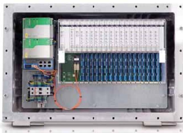
*PROGNOST®-SILver во взрывонепроницаемом корпусе (без крышки) для полевой установки (во взрывоопасной зоне)*
